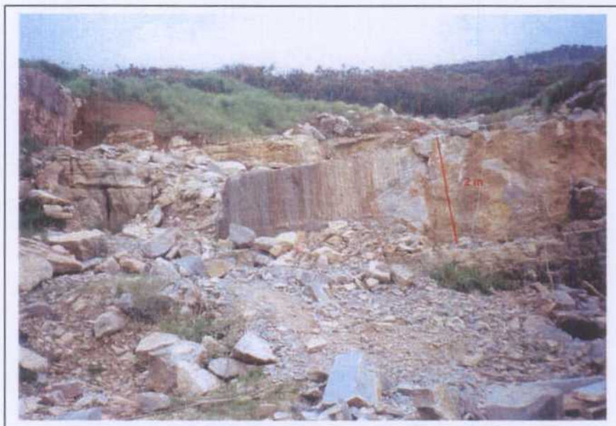
Fig. 62: Aspecto general del frente de explotación de la cantera ubicada en la E-7. En la actualidad explotan un banco de 2 m de espesor
