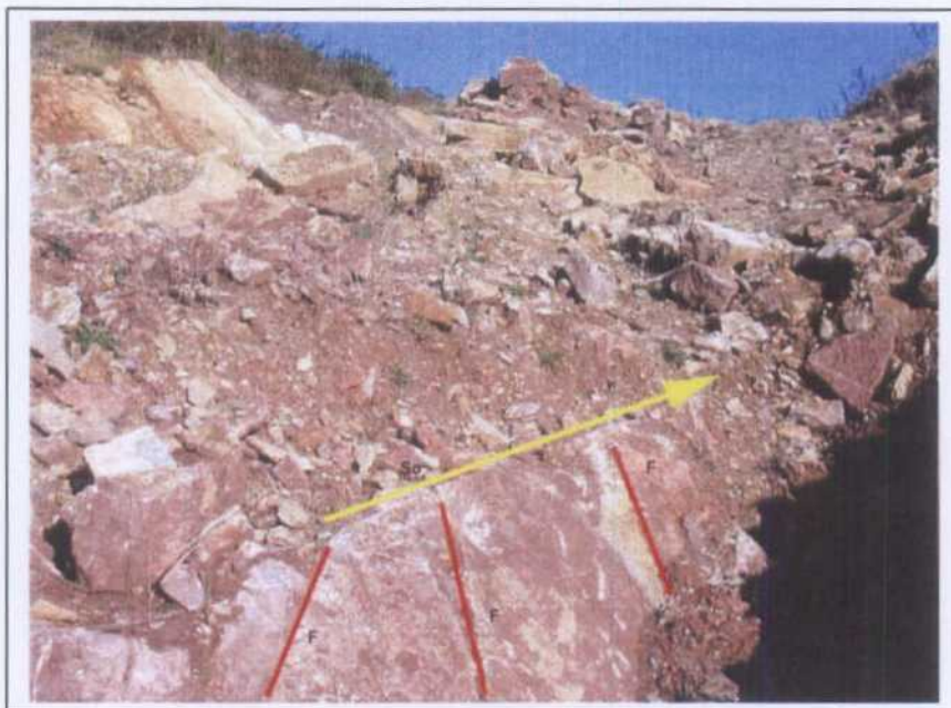
Fig.53: Vista general de la cantera, donde se aprecia la dirección de las capas y la red de fracturación
